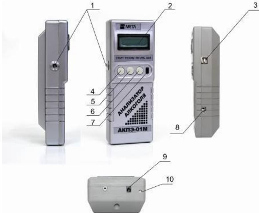
1—Гнездо для установки мундштука; 2—Индикатор; 3 – Разъем для подключения кабеля связи к принтеру; 4—Кнопка СТАРТ; 5—Кнопка РЕЖИМ; 6—Кнопка ПЕЧАТЬ; 7—Выключатель питания ВКЛ; 8 – Гнездо для установки воронки для бесконтактного экспресс анализа или фильтра; 9 - Разъем для подключения блока питания или адаптера прикуривателя; 10 - Индикатор зарядки
