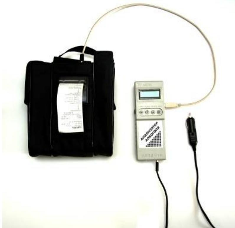
Рисунок 4 – Схема подключения измерительного блока для распечатки протокола измерения при питании от бортовой сети автомобиля через адаптер прикуривателя для прибора при упаковке в футляр (укладочную сумку)
