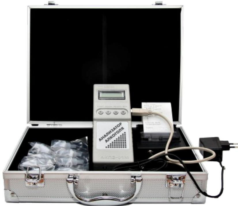
Рисунок За – Схема подключения измерительного блока для распечатки протокола измерения при питании от зарядного устройства для прибора при упаковке в футляр типа «кейс»
