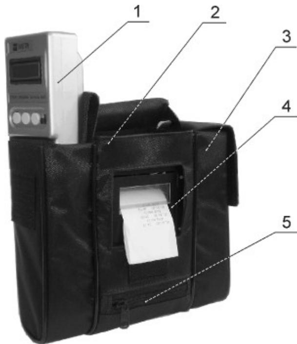
1–Блок измерительный; 2–Футляр (тканевая сумка); 3–Карман для укладки термобумаги и мундштуков; 4–Принтер; 5–Карман для укладки зарядного устройства, воронки для бесконтактного экспресс-анализа, адаптера прикуривателя и кабеля связи
