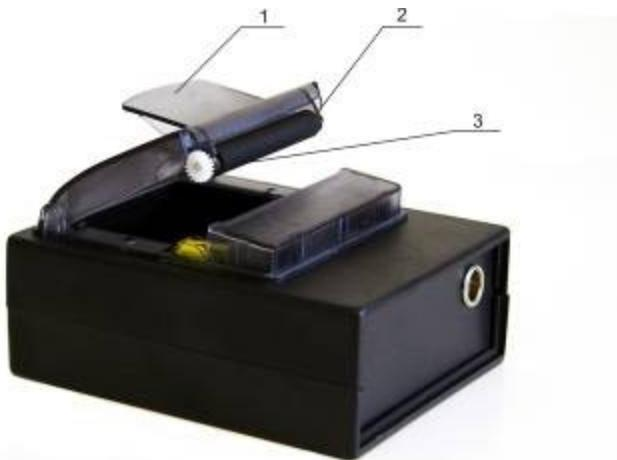
1 – Планка-рычаг; 2 – Валик; 3 – Термоэлемент
