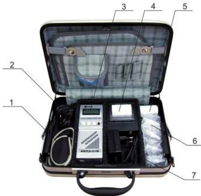
1 – Кабель связи; 2 – Кабель питания (адаптер прикуривателя); 3 – Измерительный блок; 4-Принтер; 5 – дополнительный рулон для принтера; 6 – Мундштуки; 7 – Блок питания
