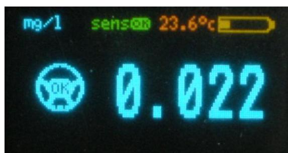
Рисунок 7 - результат измерения в мг/л (*содержание алкоголя в выдыхаемом воздухе*)
