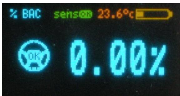
Рисунок 8 – результат измерения в %BAC (*содержание алкоголя в крови – результат получается путем пересчета из соотношения: 1%BAC = 0,05мг/л*)
